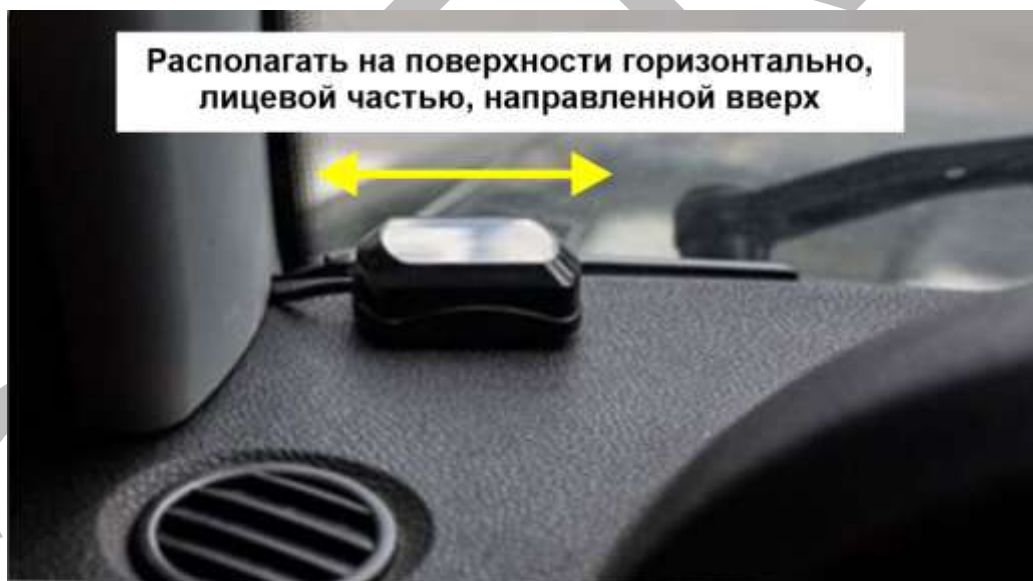
Рисунок 2.9 – Пример расположения ГЛОНАСС/GPS-антенны
