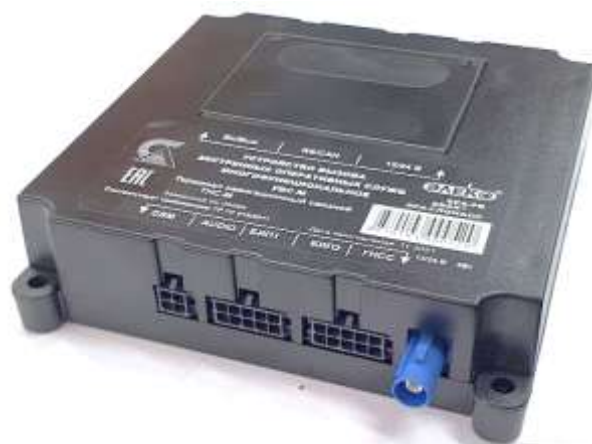
б) с внешней антенной ГЛОHACC/GPS, встроенной антенной GSM
