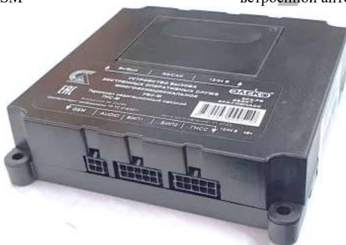
в) с встроенными антеннами ГЛОHACC/GPS, GSM
