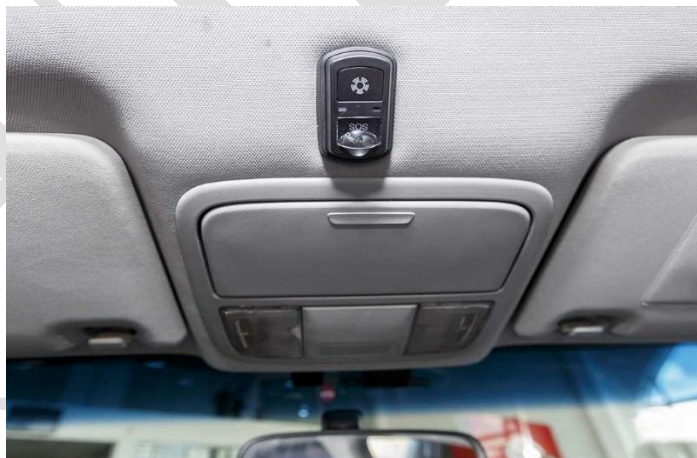
Рисунок 3.2 – Пример установки БИП в салоне ТС
