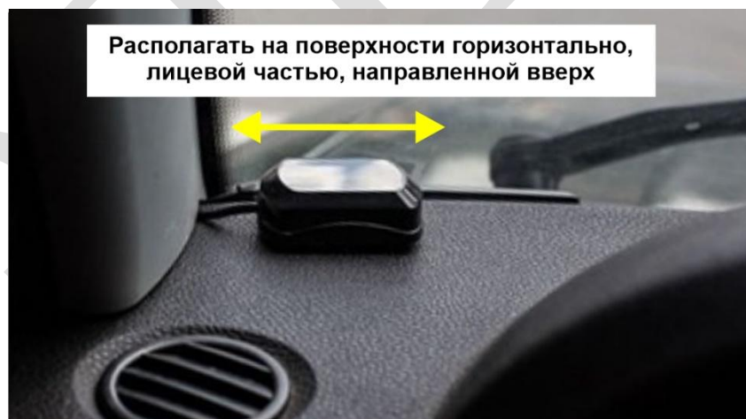
Рисунок 3.6 – Пример расположения ГЛОНАСС/GPS-антенны
