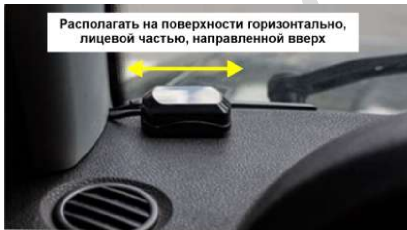
Рисунок 8.6 – Пример расположения ГЛОНАСС/GPS-антенны
