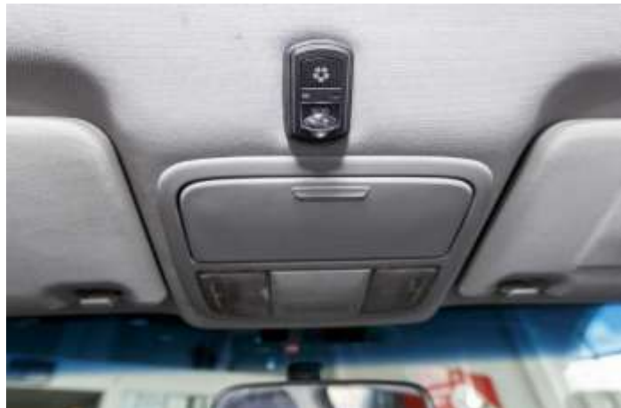
Рисунок 8.2 – Пример установки БИП в салоне ТС
