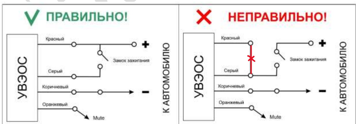
Рисунок 8.8 – Схема подключения блока ТНС к транспортному средству
